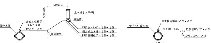
※給水口径表示のないものは $\phi 20$ とする。
