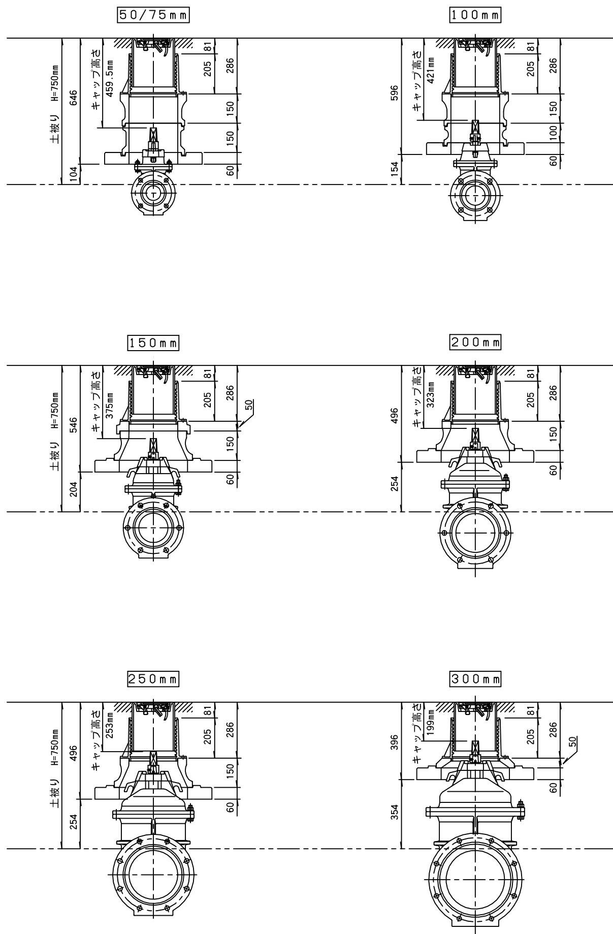
仕切弁きょう浅層埋設対応標準図(H=800)
