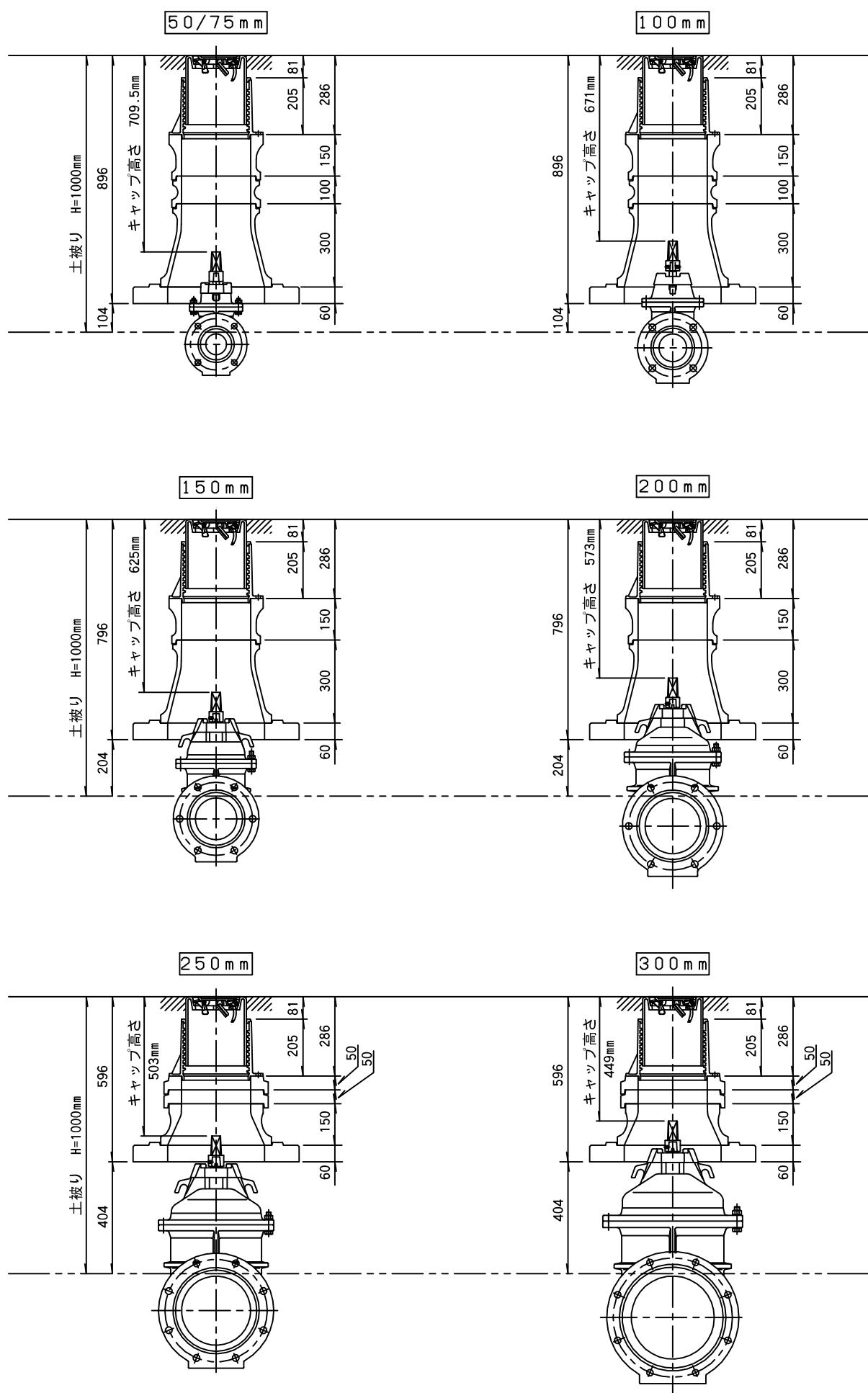
仕切弁きょう浅層埋設対応標準図(H=1050)
