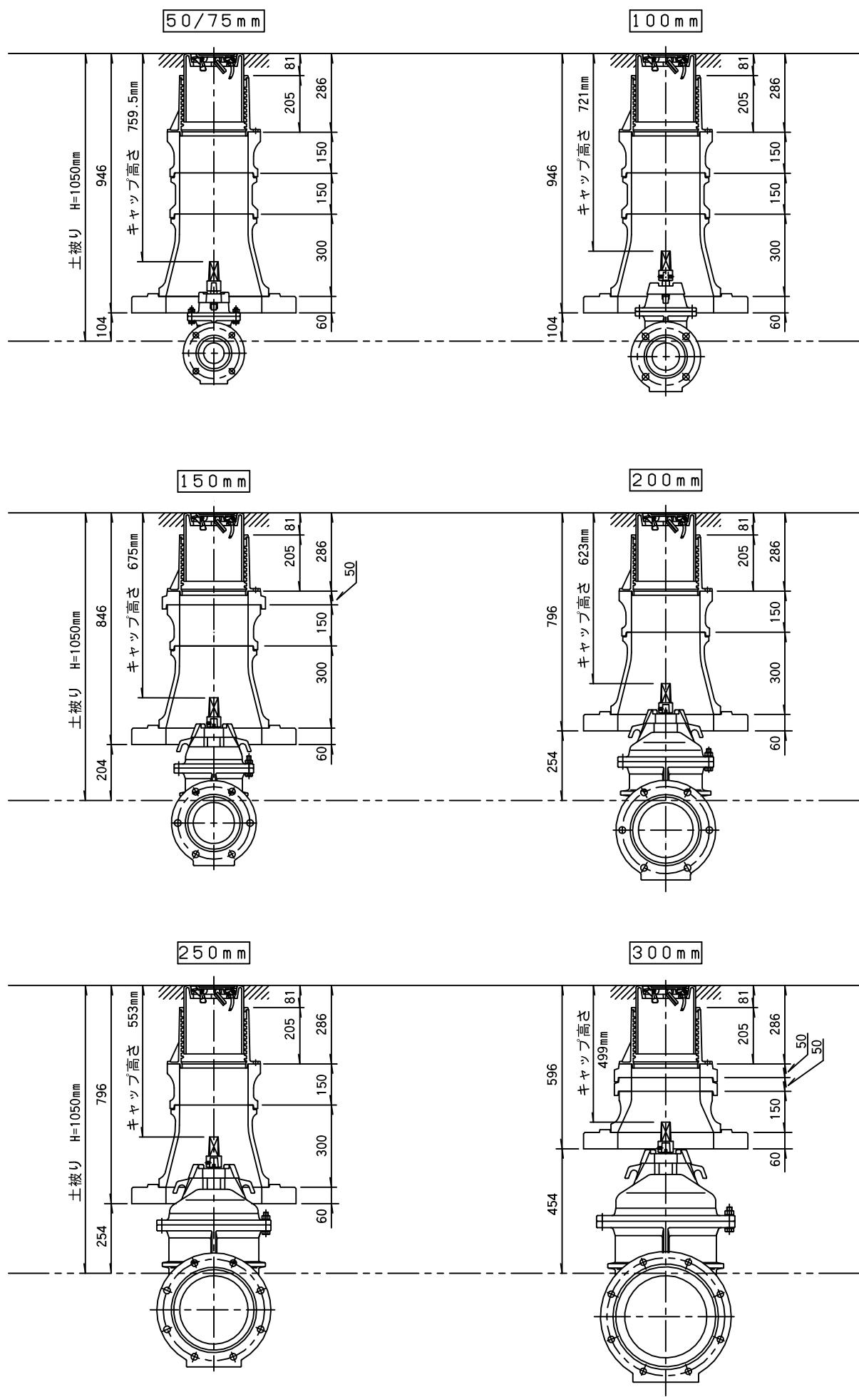
仕切弁きょう浅層埋設対応標準図(H=1100)
