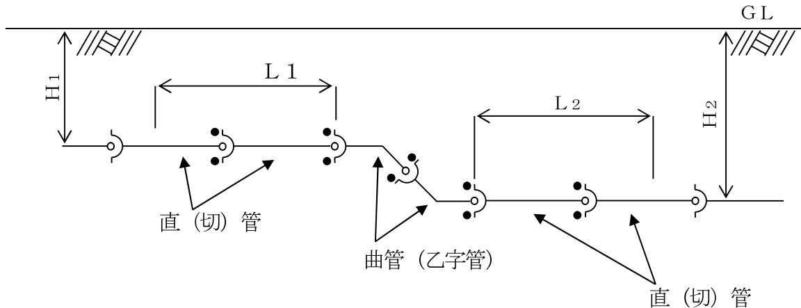
図一3 縦断S字配管(乙字管)
