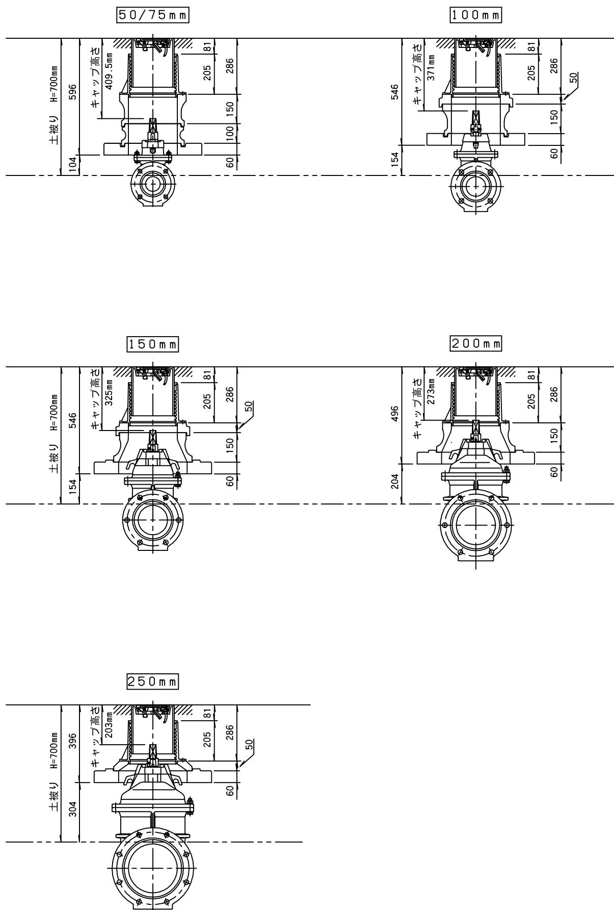
仕切弁きょう浅層埋設対応標準図 (H = 750)
