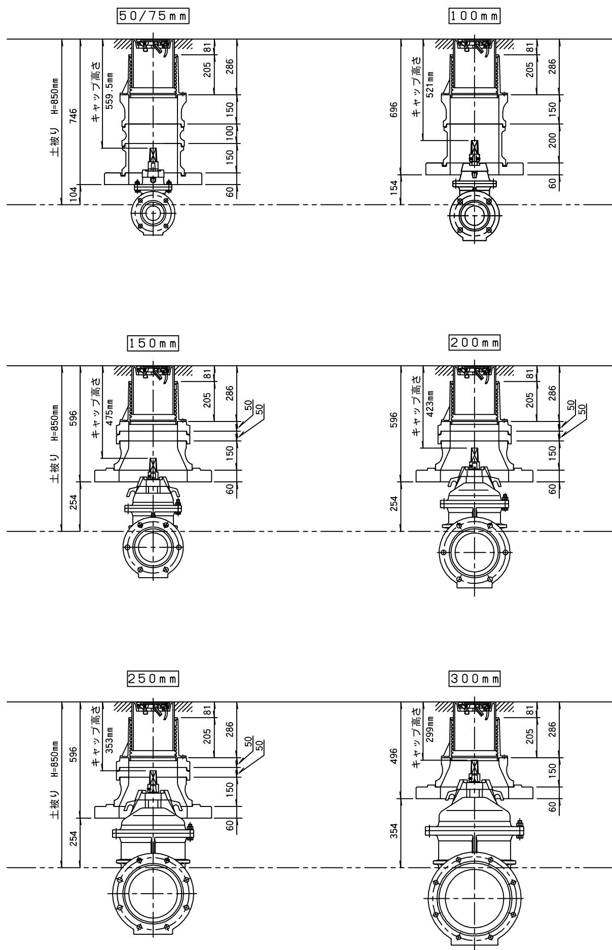
仕切弁きょう浅層埋設対応標準図 (H = 900)
