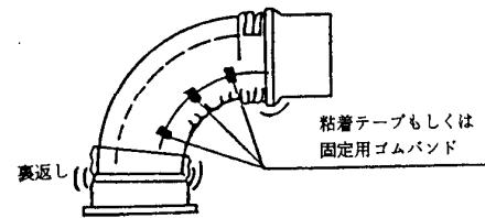
(4) 曲管部を据え付け接合後、直管部の継手と同じ要領でスリーブを管に固定する。
