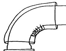
(3) 粘着テープを用いて (0.5m ピッチ) 管頂部に三重部がくるようにスリーブを固定する (直管部参照)。
