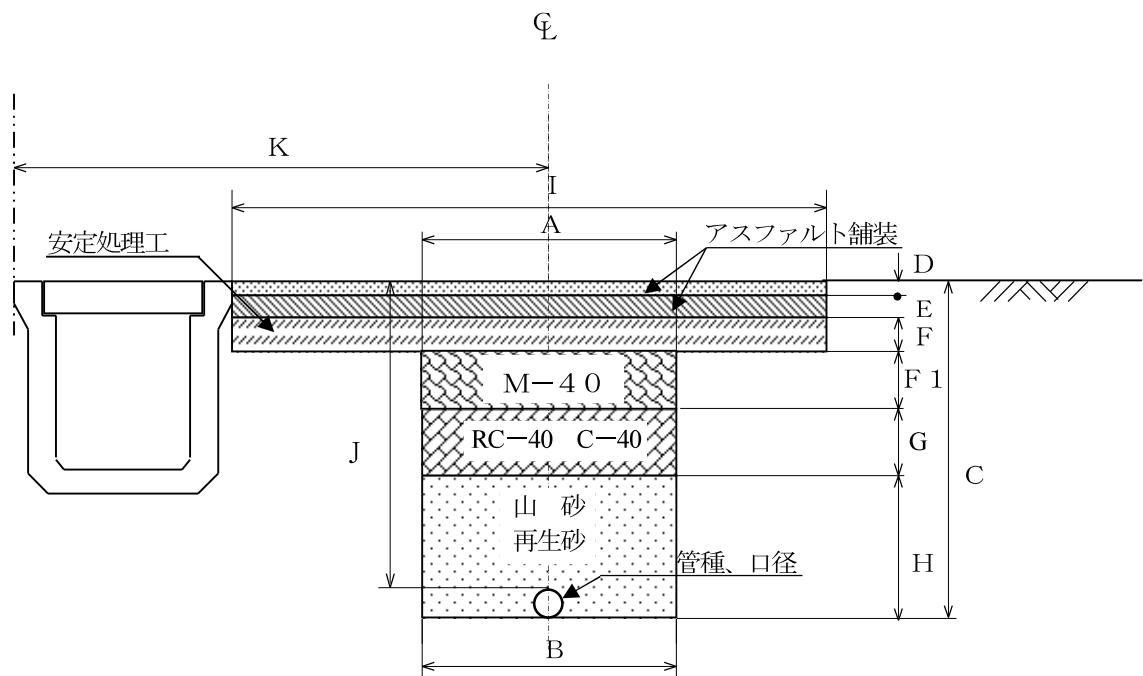
管布設工標準図 (県道:歩道)
