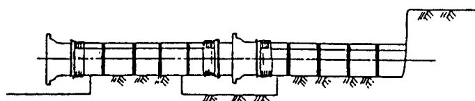
(9) 一方のスリーブを他方にたぐり寄せ、スリーブを固定用ゴムバンドで固定する。
