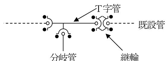
図一5既設管にT字管を連絡(本管側)
