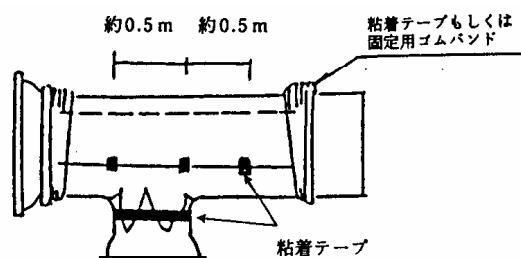
(6) 枝管用スリーブを枝管部分から挿入し、形を整える。
