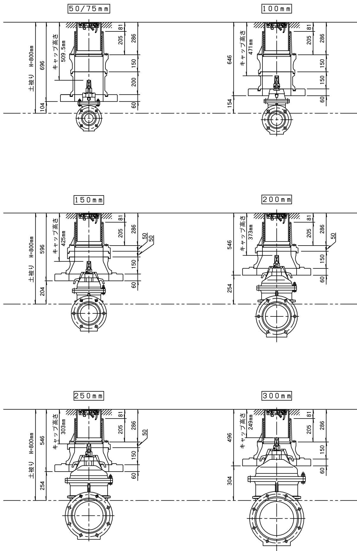
仕切弁きょう浅層埋設対応標準図 (H = 850)
