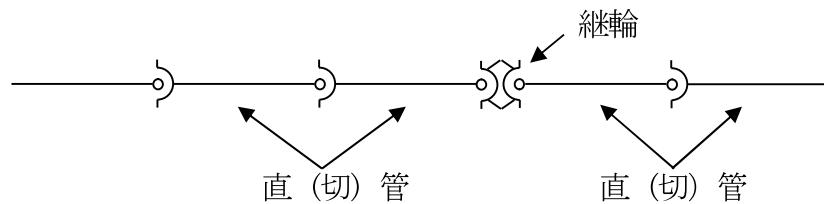
図-12 直線管路の連絡に用いる継輪
