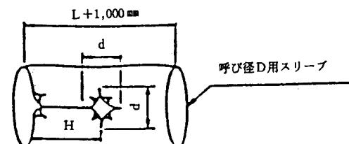
(3) 枝管部用スリーブを I 寸法に 500mm (呼径 500mm 以上は 750mm) を加えた長さに切断し、枝管部を容易に被覆できるように切れ目を入れる。
