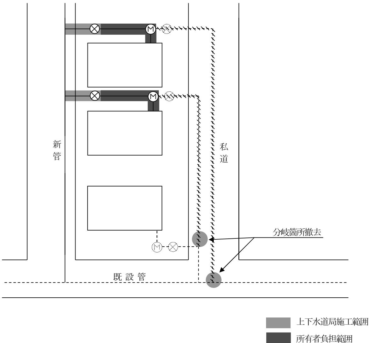
給水管の取出から止水栓（宅地内1m以内に設置すること）までの区間を布設し、分岐されていた箇所については撤去を行うものとし、第一止水栓以降の施工は所有者の負担とする。
