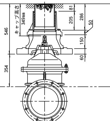
仕切弁きょう浅層埋設対応標準図 (H = 950)
