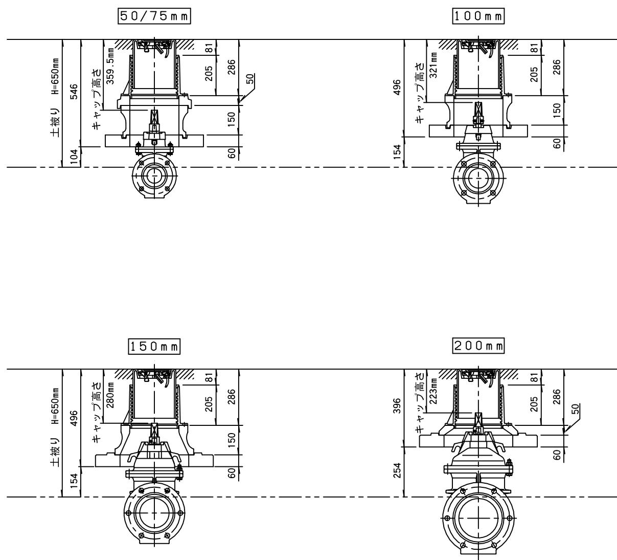
仕切弁きょう浅層埋設対応標準図 (H = 700)
