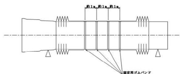
(6) スリーブの受口部および挿口部を固定用ゴムバンドで固定する。スリーブの両端を中央部に向けてたぐる。
