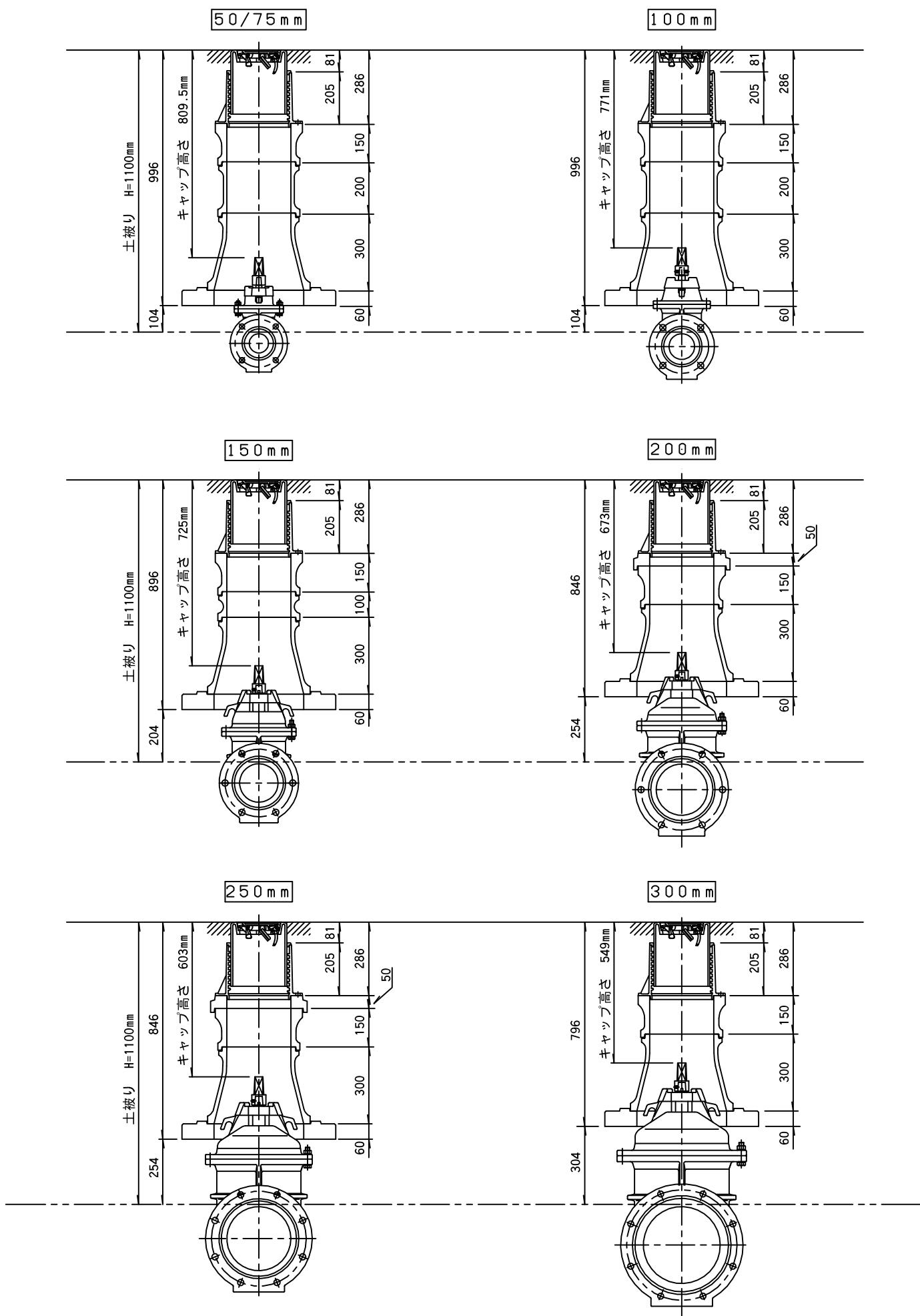
仕切弁きょう浅層埋設対応標準図(H=1150)
