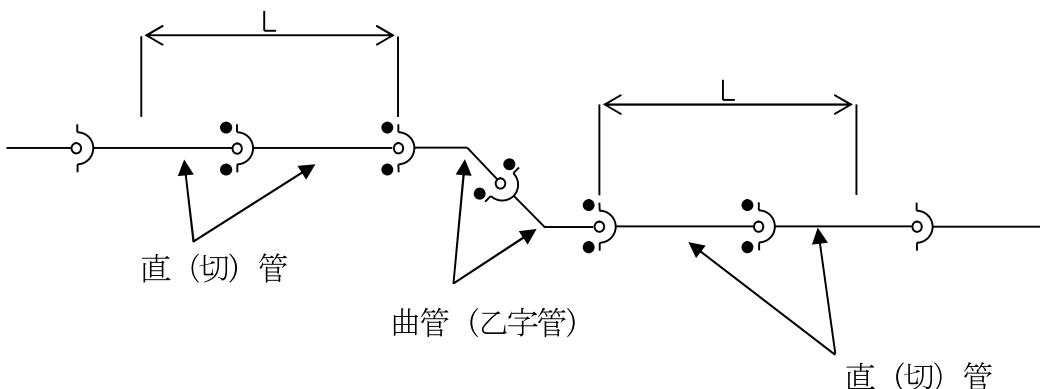
図二 水平S字配管（乙字管）
