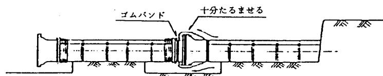
(10) 残りのスリーブも同様に十分たるませて、スリーブ端を固定用ゴムバンドで固定する。
