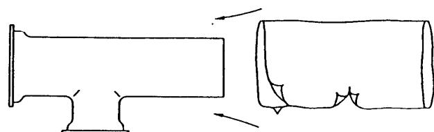
(5) スリーブを直管と同様の方法で管に固定する。また配水管用ポリエチレンの枝管部まで切れ目を入れた箇所を、粘着テープで管に固定する。
