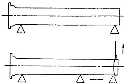
(2) 挿口部を吊り、管台を中央まで移動させる。
