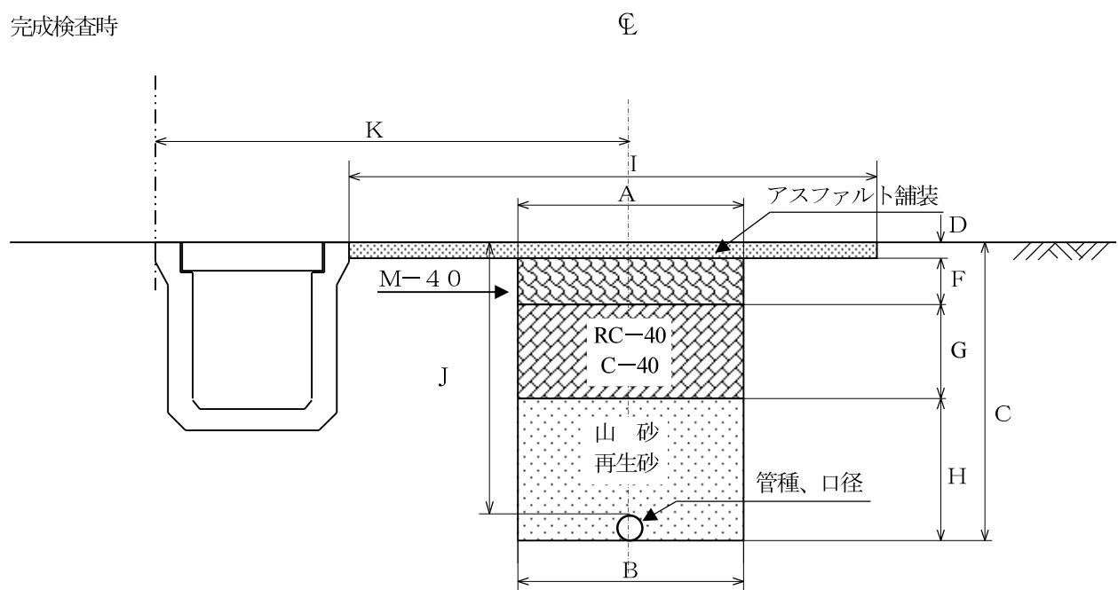
管布設工標準図（砂利） 参考図
