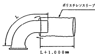
(2) 挿入されたスリーブを管全体に移動させ、形を整える。
