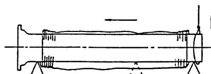
(5) 固定用ゴムバンドを用いて (1mピッチ) 管頂部に三重部がくるよう にスリーブを固定する。
