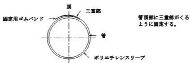
図1-2 継手部の施工方法
