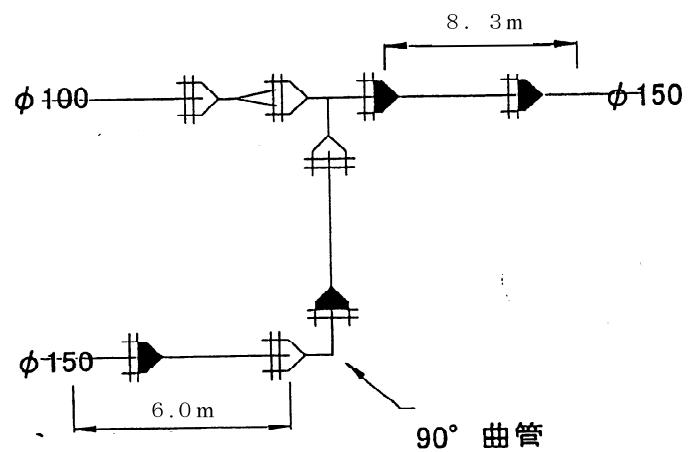
添付図 7 T字管+片落管+曲管
