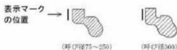
図-3.16 ゴム輪(直管用)の表示マーク位置
