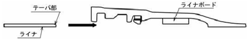
図-3.44 ライナのセット (呼び径 75~250)
