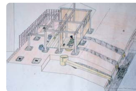
■推定イラスト 床板が張ってあった場合の推定図です。復元では土間を採用しました。
