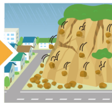
小石がぼろぼろ落下 亀裂の発生
