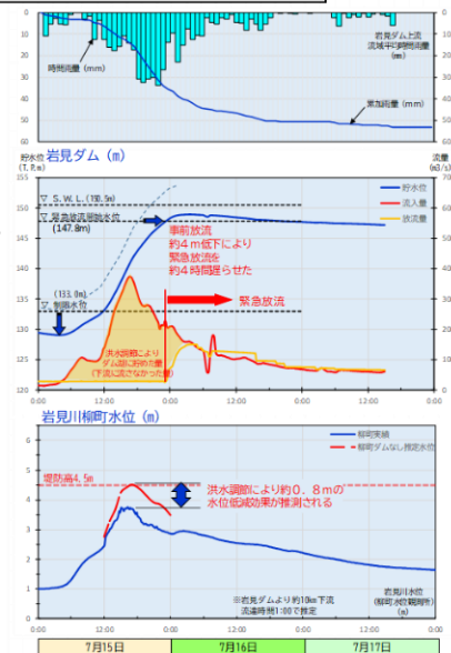
7月15～16日の豪雨における岩見ダムの洪水調節効果
