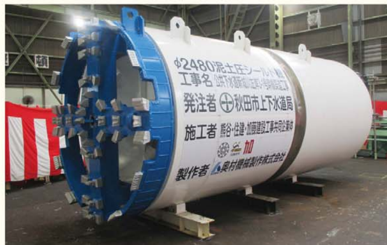
雨水幹線工事に使用するシールドマシン
